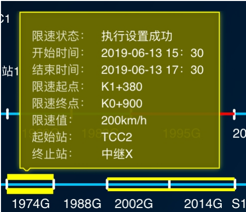
图 C.12 正线临时限速悬浮框显示示意图
