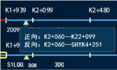
图 C.10 应答器正反向临时限速管辖范围显示界面示意图
