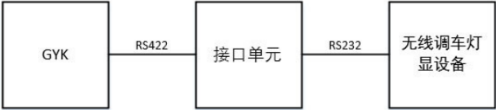
图 H. 8 GYK型与无线调车灯显设备串口接口框图
