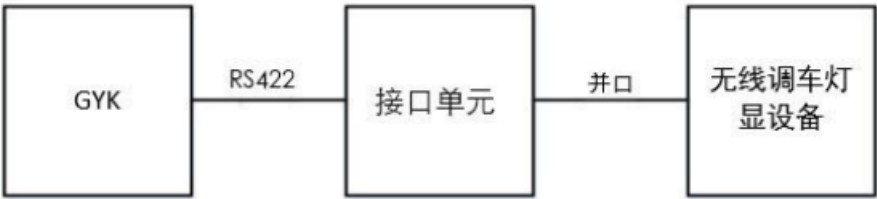
图 H. 7 GYK型与无线调车灯显设备并行接口框图
