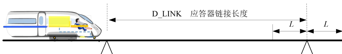
图 18 应答器链接示意图
